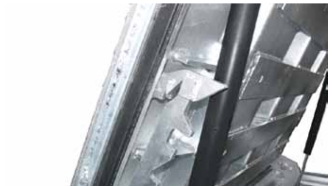
Getande blokkeerstang als beveiliging tegen dichtklappen.
